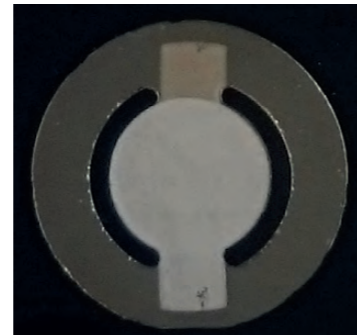
Abbildung 9: Freischwinger, thermisch und mechanisch entkoppelter Resonator
