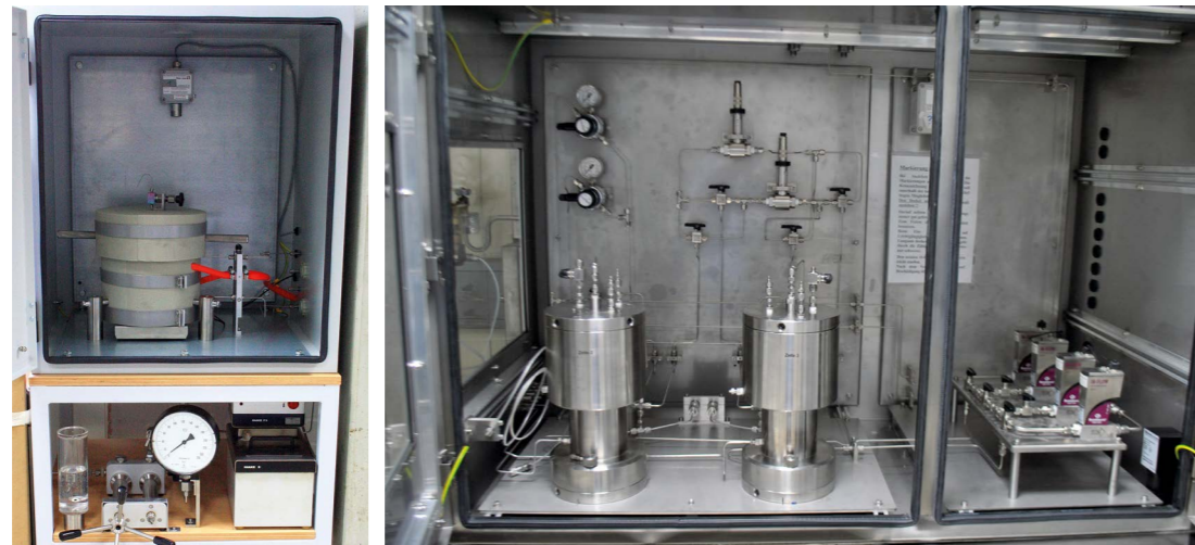
Abbildung 2: Autoklav für HPHT-Wasserstoffexperimente (links) und Permeabilitätsmesszellen für Versuche mit H_2 (rechts) nach abgeschlossenem Auf- bzw. Umbau.
