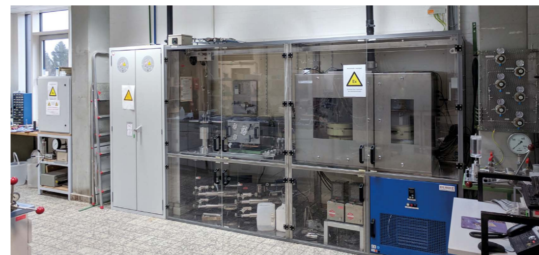
Abbildung 1: Gesamtansicht der für die Versuche mit H 2 auf- bzw. umgebauten Anlagen mit dem Autoklav im linken Sicherheitsschrank, den Permeabilitätsmesszellen im rechten Sicherheitsschrank und dem dazwischen aufgestellten Flaschenschrank.
