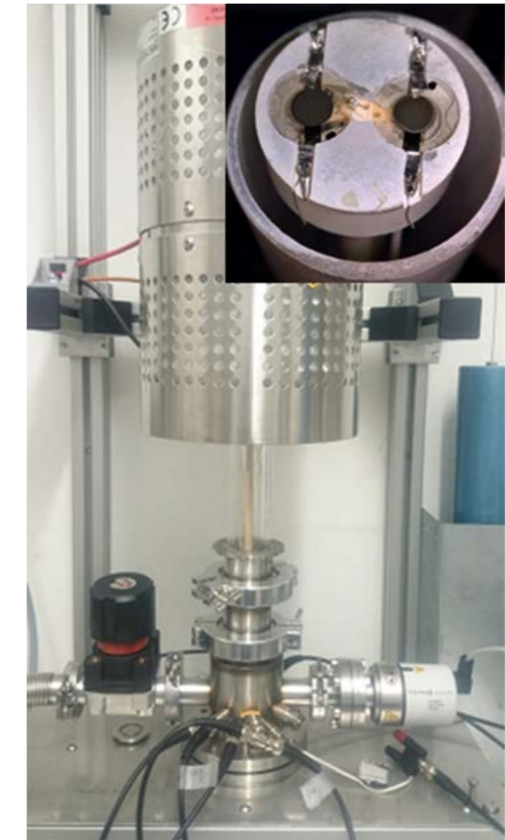
Abbildung 3: Fotografie des zweiten Dünnschichtkalorimeters mit Rohrofen in Messposition; der Einsatz zeigt den Doppelprobenhalter mit zwei eingebauten Resonatoren
