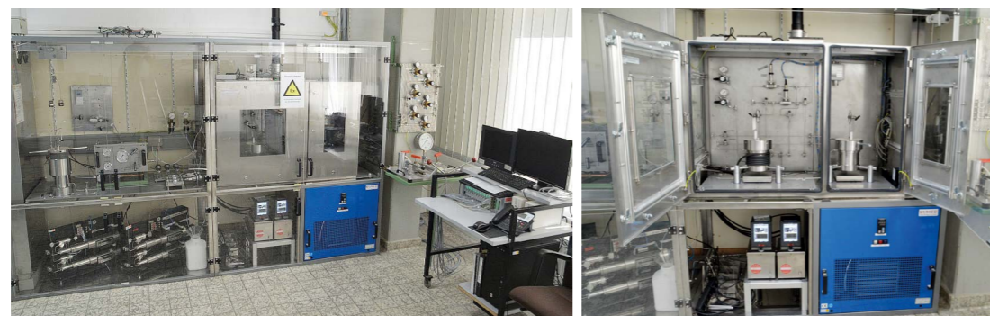
Abbildung 1: Messeinrichtung mit der Permeabilitätsmessanlage für die Messung der Permeabilität der Probekörper unter Reservoirbedingungen (links) und den explosionsgeschützten HPHT Autoklaven für Wasserstoffexperimente (rechts).
