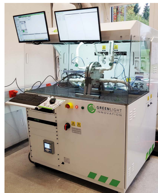
Abbildung 1: Neuer Teststand für die alkalische Wasserelektrolyse (30 bar, 90 °C, 14 kA m 2 ).
