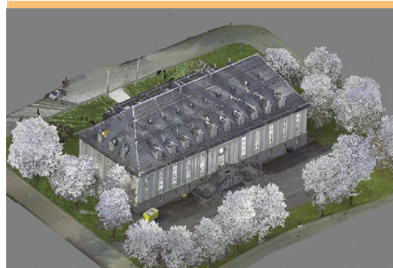
Aufnahme einer 3D-Punktwolke der Aula Academica der TU Clausthal. Die Analyse und Interpretation der per Laserscanner erfassten Daten erfolgt auf Rechnern des SWZ, Foto: Institute of Geo-Engineering, TU Clausthal.
